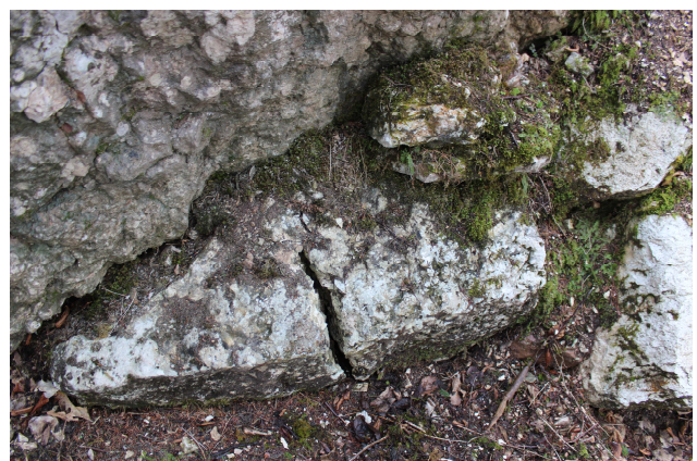
Foto 3.3.2 e 4.3.2: da sinistra la fessura di un blocco alla base del grande masso in "avanzamento" sulla strada a novembre 2017 e ad aprile 2018. In poco più di 4 mesi la fessura si è aperta di qualche millimetro, mentre lo spostamento del blocco sovrastante è dell'ordine dei centimetri.
