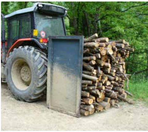
**Img. 91** Gabbia portata sul sollevatore idraulico posteriore
