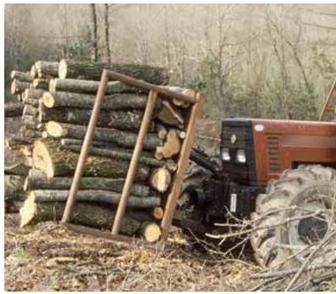
**Img. 92** Gabbia portata sul sollevatore idraulico anteriore
