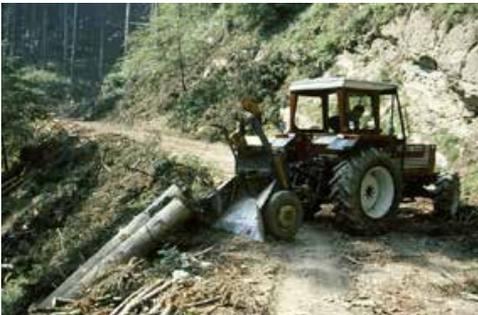
Img. 72 *Trattore con verricello carrellato per l'esbosco a semistrascico*
