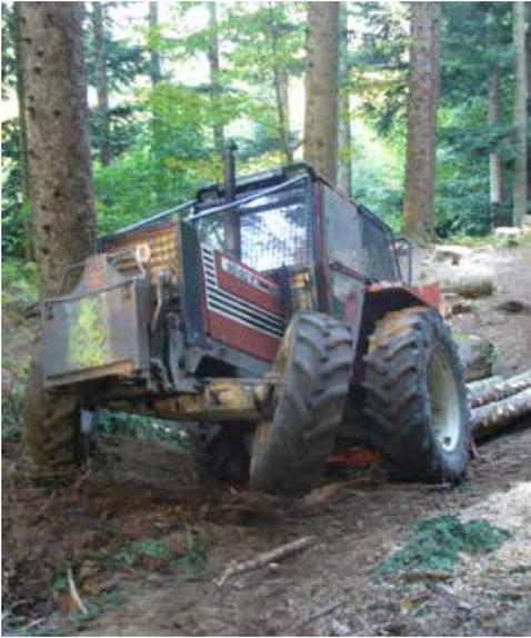
Img. 71 *Impennamento del trattore durante l'esbosco a strascico*
