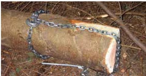
Img. 62 Cavo a strozzo in catena d'acciaio
