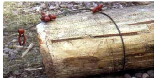
Img. 63 Cavo a strozzo in fune d'acciaio con choker
