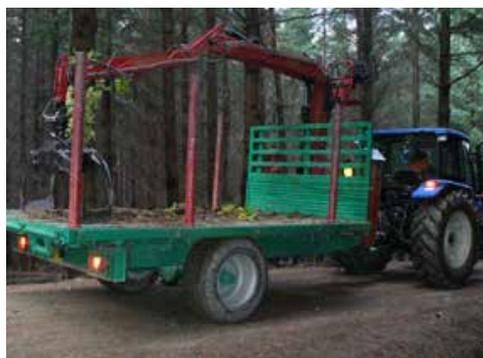
Img. 86 *Trattore con rimorchio e gru idraulica*
