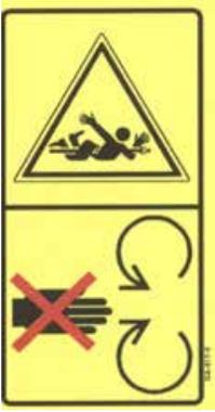
Img-82 Pittogramma relativo al pericolo di impigliamento e trascinamento
