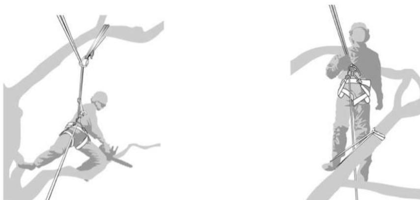
Si tratta generalmente di lavori eseguiti su piante di alto fusto. Per salire sugli alberi si deve fare ricorso, normalmente (montaggio e smontaggio di impianti di gru a cavo), a tecniche di salita mediante ramponi metallici, fissati all'altezza del piede e della caviglia dell'operatore, e di una imbracatura (art. 115 del D.Lgs. 81/08 e s.m.i.); nel caso di potature, a scale o a tecniche di salita con funi, treeclimbing (art. 116 del D.Lgs. 81/08 e s.m.i.).
